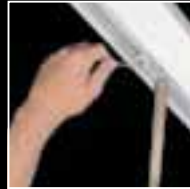
Stilling á viðnámshemlum. Rennikubburinn í viðnáms-hemlunum hertur (sexkantur) eins og sýnt er.
